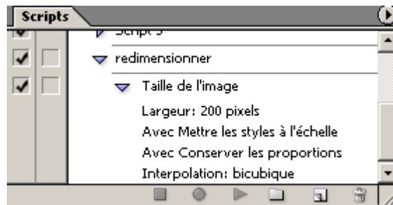
C'est important car, si les images du dossier ne sont pas toutes de la même taille, une réduction de la largeur de 30% par rapport à l'original (*relative*) est très différent d'une réduction de la largeur à 200 pixels (*absolue*).
