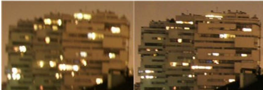
Détail d'une photo prise sans stabilisateur (à gauche) et avec stabilisateur (à droite) à main levée et à une vitesse d'obturation de 0,6 seconde.
